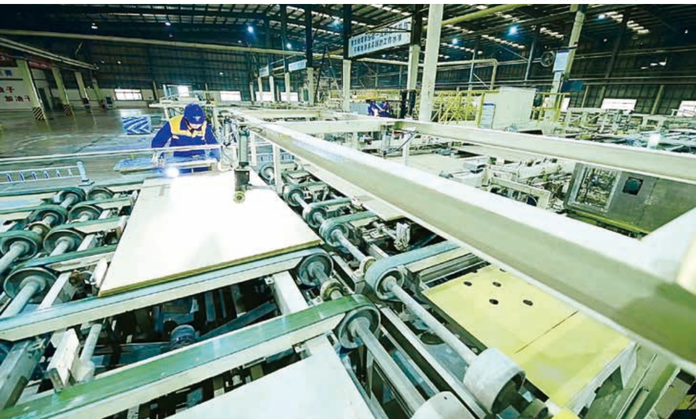
苏州北新石膏板生产线
