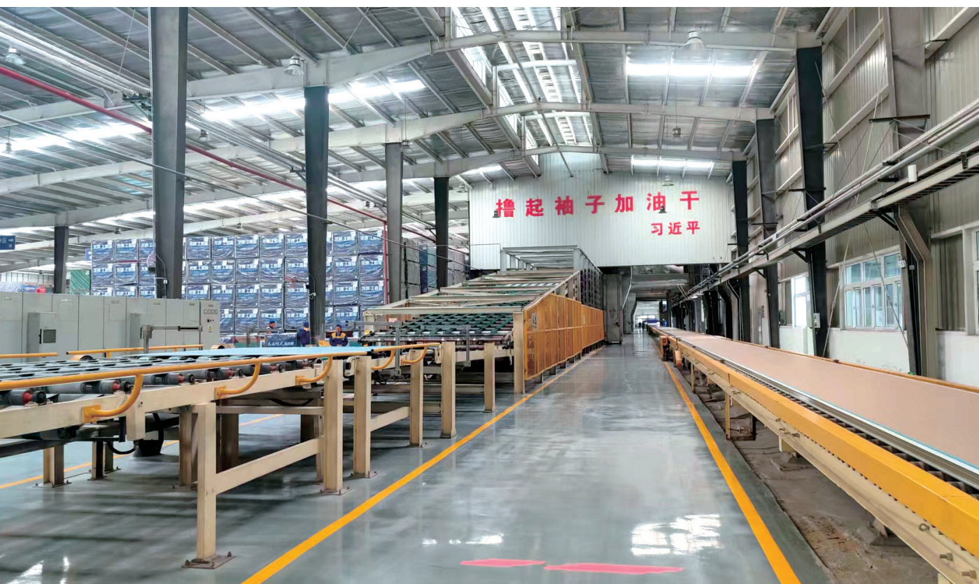
龙牌公司天津北新石膏板生产线
